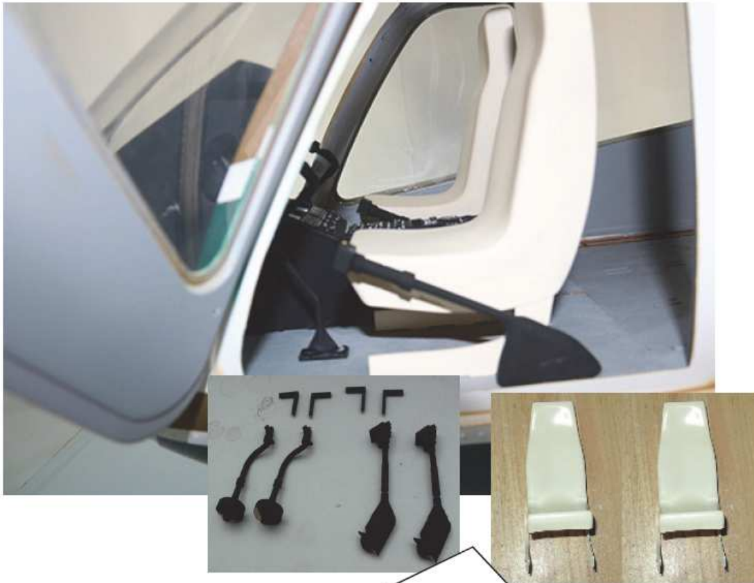
Install front cockpit parts 【60】 【64】 【65】 【66】 【67】 as shown with glue.
