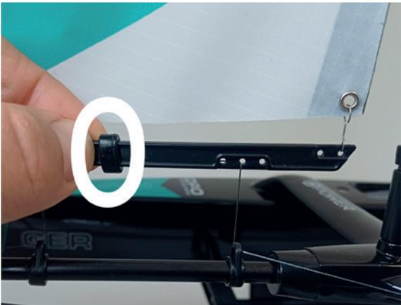
Den Silikonring am Vorsegel-Ausleger verschieben, bis der Abstand zwischen dem Ende des Auslegers und dem Hauptmast 15-20 mm beträgt.
