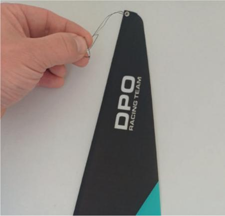
Die Schlaufe der oberen Leine vom Vorsegel in die Aufnahme oben am Mast einhängen.
