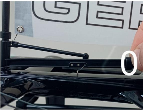
Den Silikonring am Hauptsegel-Ausleger verschieben, sodass der Ausleger des Hauptsegels exakt parallel zur Rumpfmittelachse steht.
