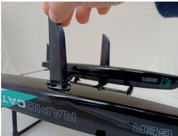
Die beiden Kiele wie abgebildet einstecken und darauf achten, dass diese bündig mit dem Rumpf sind. Die Einbaurichtung der Kiele beachten.
