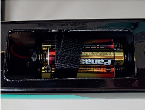
Die drei AAA Batterien in die entsprechende Halterung rechts im Rumpf einlegen. Beim einlegen der Batterien auf die richtige Polung achten! Die eingesetzten Batterien gegen verrutschen mit dem Klettverschluss sichern.
