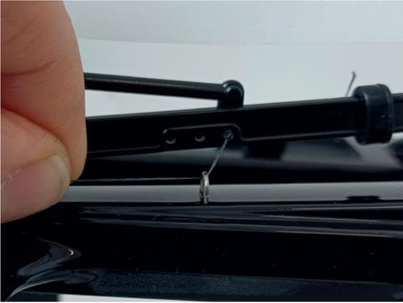
Die Leine des Hauptsegel-Auslegers erst durch die Öse am Deck in der Mitte und danach durch die Öse am Deck vorne links ziehen. Die Schlaufe der Leine hinten in den Hacken einhängen.
