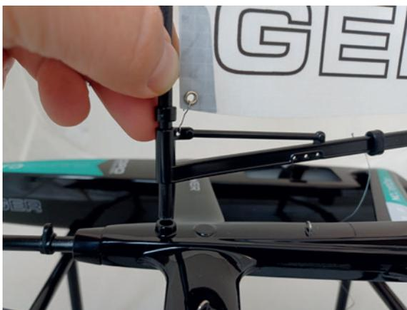
Den Mast des fertig montierten Segels in die Masthalterung am Rumpf stecken.
