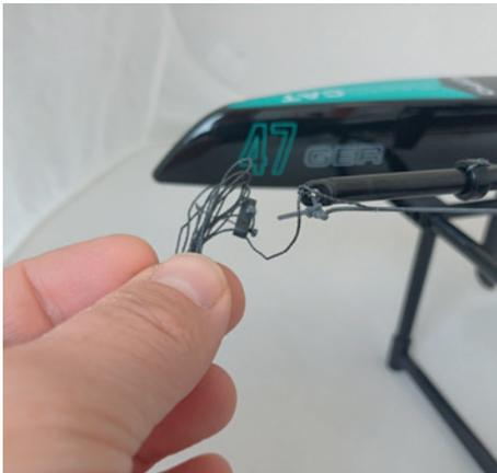
Die Leine am vorderen Ende des Holms nehmen und die Schlaufe oben am Mastkopf einhängen.
