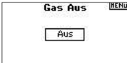
Wählen Sie in der Funktionsliste Motor Aus. Drücken Sie den Roll Druck Taster zur Auswahl. Wählen Sie das Feld -Deaktiviert- Drücken Sie den Taster und wählen Sie durch drehen den gewünschten Schalter. Bestätigen Sie die Auswahl durch Druck auf den Schalter.
