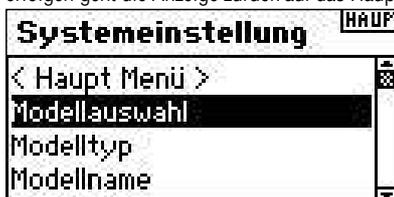
Drehen Sie den Roll Druck Taster auf das Modell und drücken den Taster zur Auswahl. Das Modell ist nun gewählt und der Name (MDL01-Acro) wird auf dem Display angezeigt.
