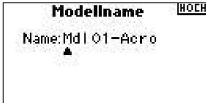
Wählen Sie durch drehen den gewünschten Buchstaben und drücken dann den Taster. Wiederholen Sie diesen Vorgang bis der Name komplett ist. Mit Druck auf die CLEAR Taste löschen Sie einen Buchstaben.
