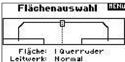
Wählen Sie den Flächentyp NORMAL und drücken dann den Taster um die Auswahl zu bestätigen. Der Leitwerkstyp ist in diesem Beispiel auch normal und erfordert keinen Wechsel in der Programmierung.
