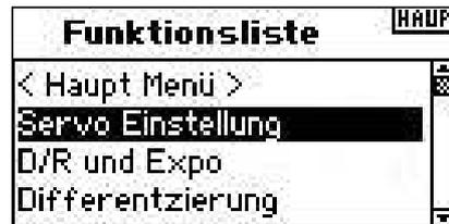
Wählen Sie mit dem Roll Druck Taster Servoeinstellungen und rücken dann den Taster zur Auswahl. Wählen Sie im Feld Weg die Servoumkehrfunktion.
