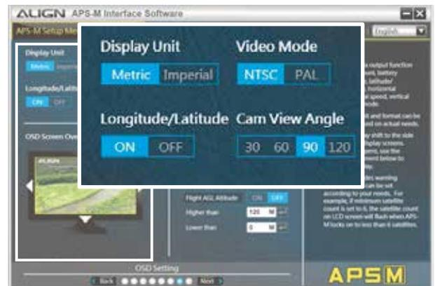
2. Falls die OSD Anzeige auf dem Bildschirm verschoben ist, kann die Position über **OSD Screen Overlay Position** nachjustiert werden.
