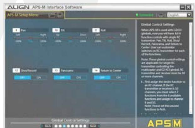
2) Für die Funktionen Pan, Tilt und Roll sollten Proportionalgeber wie Schieberegler oder Drehknöpfe am Fernsteuersender verwendet werden.
