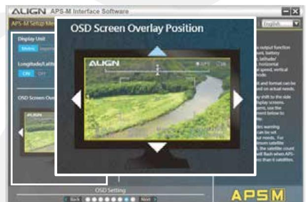
3. Das OSD bietet auch die Möglichkeit bestimmte Warnmeldungen anzuzeigen. Z. B. kann man das Symbol für die Anzahl der Satelliten aufblincken lassen, falls die Anzahl der erkannten Satelliten unter eine bestimmte Schwelle fällt. Stellen Sie die entsprechenden Parameter unter **OSD Warning Parameters** ein.
